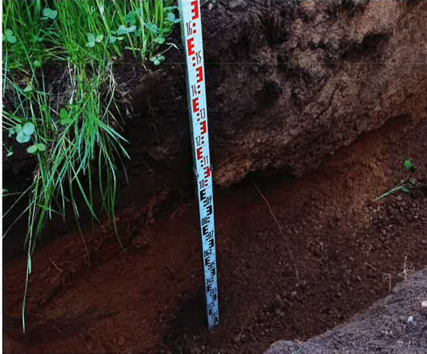
Baggerschurf BS 4: Aufnahme Schurfprofil am 20.05.2021
