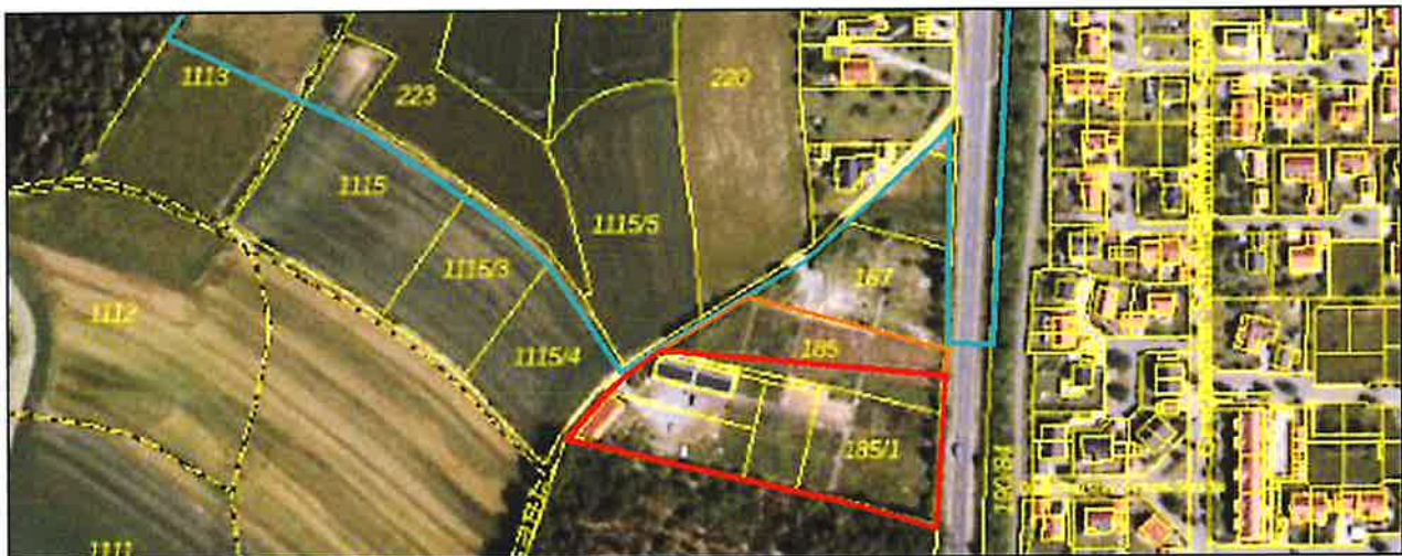
Abbildung 1: Luftbildaufnahme mit Kennzeichnung des Umgriffs der Altablagung (rot), der Altlastenverdachtsfläche gemäß Altlastenkataster (orange) und des Umgriffs des Baugebiets (türkis). Quelle Luftbild: BayernAtlas PLUS
